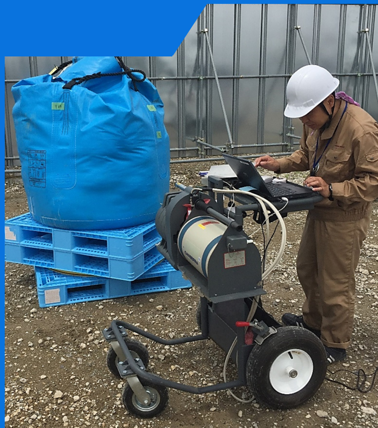
現地における放射線計測 ISOCSSを用いたHPGeにより大型土のう袋を計測
