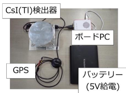
図1 屋外マッピングのための可搬型装置
