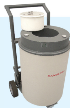
JCC-51型 アクティブWell型 中性子コインシデンスカウンタ
