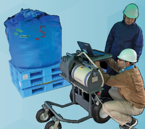
現地における放射線計測 ISOCSSを用いたHPGeにより大型土のう袋を計測
