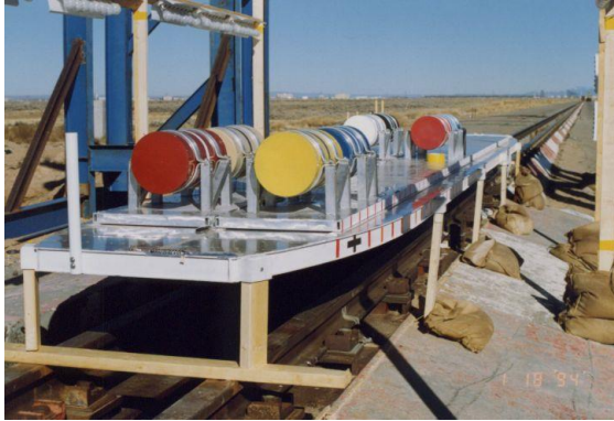
コンテナの固縛装置及び輸送物を模擬した1／5スケールモデル
