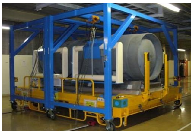
UF6 シリダ ® 中のウラン量測定装置 (UCAS) (*)
