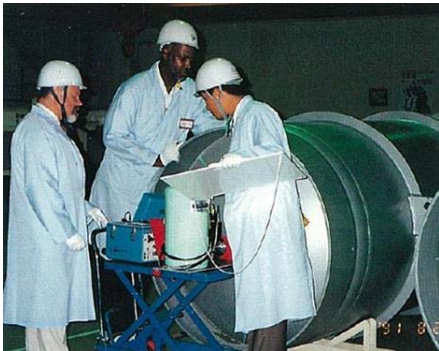
写真3 ウラン濃縮度測定
