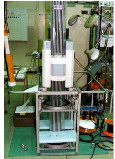
写真4 ウラン量測定(UNCL)
