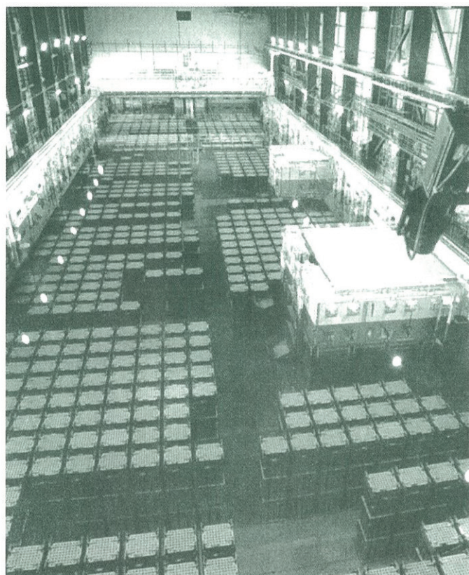
使用済燃料の貯蔵プール（コジェマ社パンフレットより）
