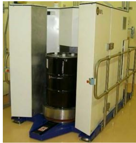
廃棄物ドラム中の核物質測定装置 (WDAS) (*)
