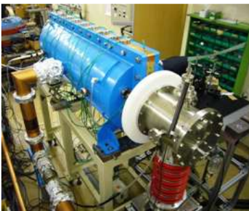
2ビームRFQ線形加速器 原理実証機
