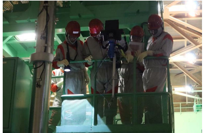
XCVD*による使用済燃料プール内の検認の様子
